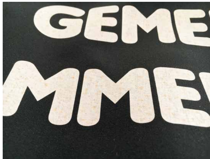
Bei elastischen Fasern wie Lycra oder Elastan lösen sich Dispersionspigmente schon bei niedrigen Temperaturen aus dem Faserverbund.
