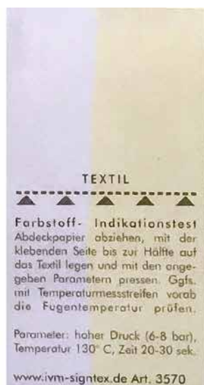
leichte Verfärbung, wenig freie Pigmente auf der Oberfläche - je nach Qualität geht noch Niedertemperaturfolie (FlexCut X4 kann einige Pigmente blocken)
