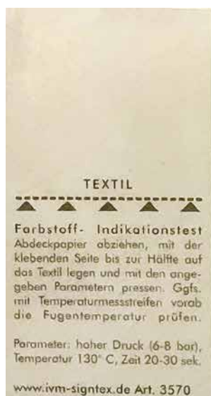
keine Verfärbung, keine freien Pigmente auf der Oberfläche - Niedertemperaturfolie verwenden (z.B. FlexCut X4)
